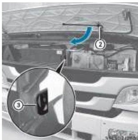
Wartungsklappe ohne Dämpfer
