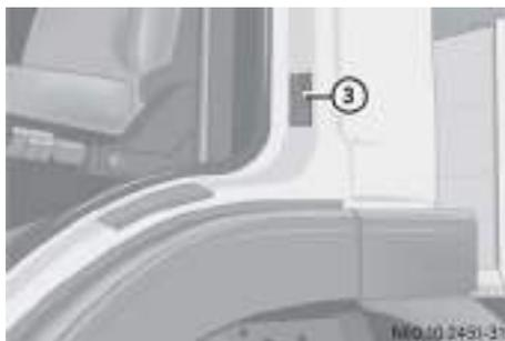
Die Fahrzeug-Identifizierungsnummer (VIN) ③ ist zusätzlich im Türrahmen auf der Fahrerseite.
