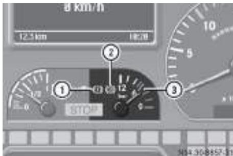
Den Bremskreis mit dem niedrigeren Vorratsdruck zeigt die Kontrollleuchte ① oder ② an. An der Anzeige ③ sehen Sie den Druck in diesem Bremskreis.
