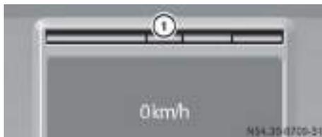
Um Display-Meldungen nach der Wertigkeit zu unterscheiden, gehen einzelne Segmente der Statusanzeige ① gelb oder rot an.
