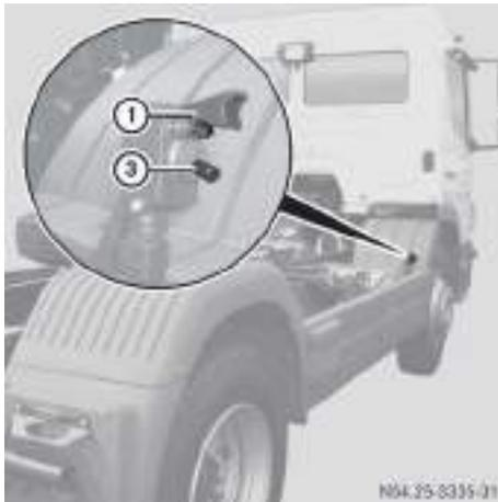
NOT-AUS-Schalter hinter dem rechten Radeinbau (Beispiel)
