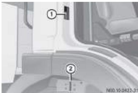
Das Fahrzeugtypschild ① ist im Türrahmen auf der Beifahrerseite.
