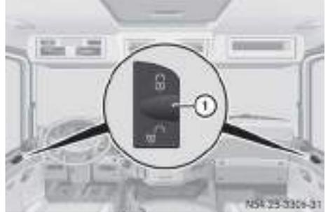
Bei Fahrzeugen mit Zentralverriegelung werden automatisch beide Türen ver- und entriegelt, wenn Sie
