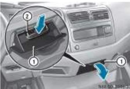
Aschenbecher im Fernverkehr-/Verteiler-Cockpit
