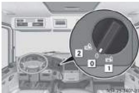
Schalten Sie das Verteilergetriebe im Fahrbetrieb immer in Straßen-Schaltstellung **1** oder Gelände-Schaltstellung **2**.
