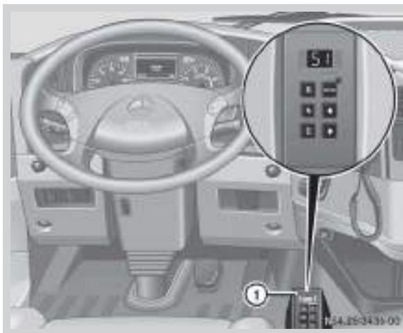
Das Automatikgetriebe schaltet automatisch alle 5 oder 6 Vorwärtsgänge. Die Fahrstellung **D** ergibt in fast allen Betriebs-situationen optimales Fahrverhalten.
