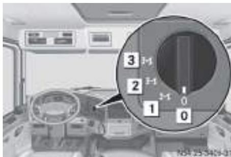
Schalter Ausgleichsgetriebesperren (Beispiel)
