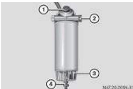
Kraftstoff-Vorfilter (hinter dem Fahrerhaus oder am rechten Fahrzeugrahmen)
